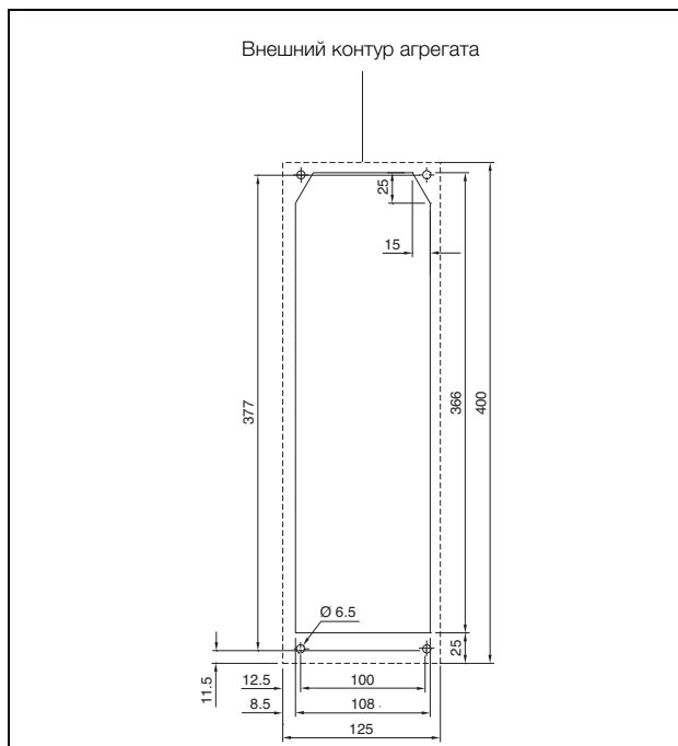
Рис. 32: Монтажный вырез и размеры отверстий при наружном монтаже
